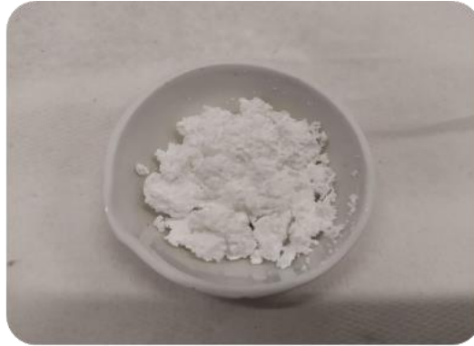
Figura 3.2 . Catalizador nanoestructurado de titanatos de sodio.
