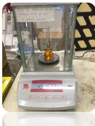
Figura 2.5 . Matraz aforado con muestra en balanza analítica.
