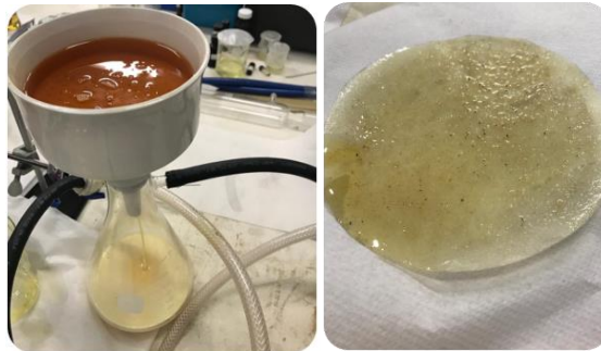
Figura 2.2 . Filtrado del aceite con bomba de vacío.
