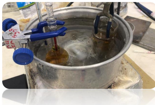
Figura 2.6 . Matraz aforado con muestra en baño maría.
