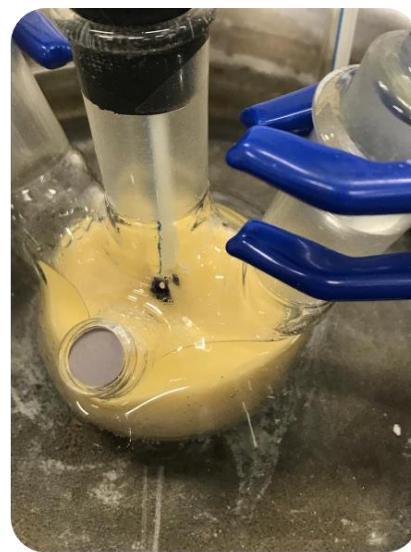
Figura 2.21 . Reactor de vidrio de bola de tres bocas al final de una reacción.
