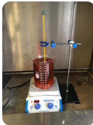
Figura 2.3 . Secado de aceite a 110 ^{\circ}\text{C} en parrilla StableTemp.
