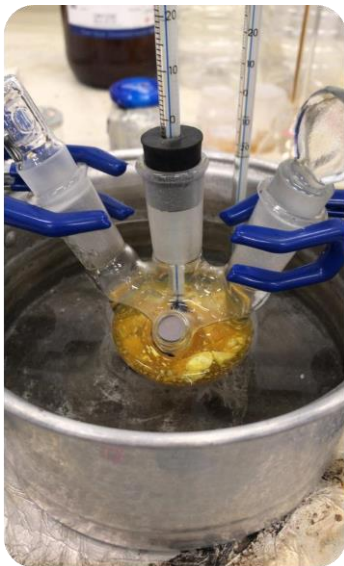
Figura 2.20 . Reactor de vidrio de bola de tres bocas al inicio de una reacción.
