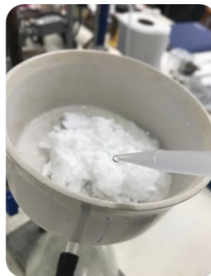
Figura 2.15 . Lavado y filtrado con bomba de vacío.
