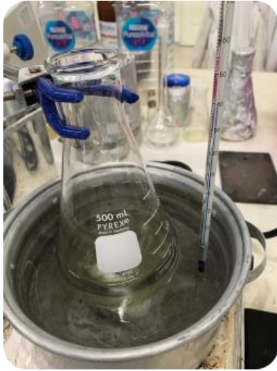
Figura 2.12 . Matraz aforado con muestra en baño maría.
