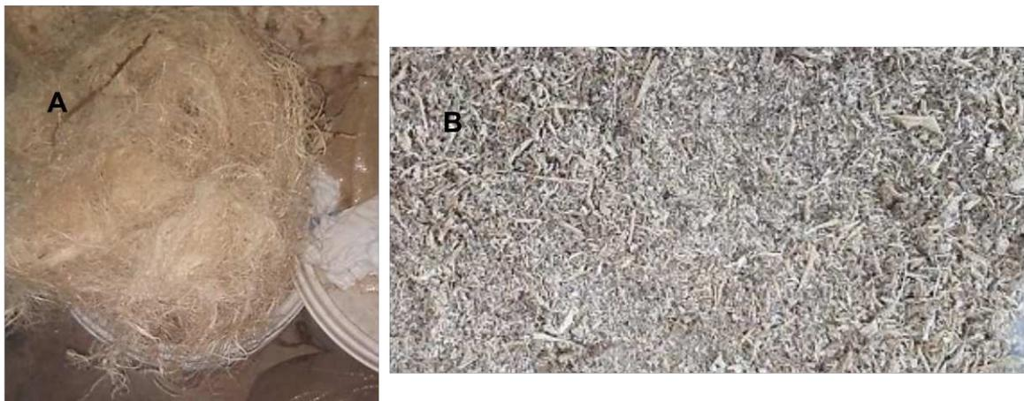
Figura 2. 3 Componentes del bagazo de henequén. A) Fracción fibrosa, B) Fracción no fibrosa
