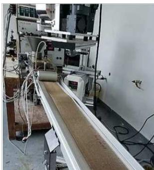
Figura 2. 8 Obtención de las láminas de material compuesto en el extrusor doble husillo
