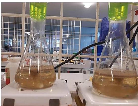
Figura 2. 6 Sistema para la extracción con agua
