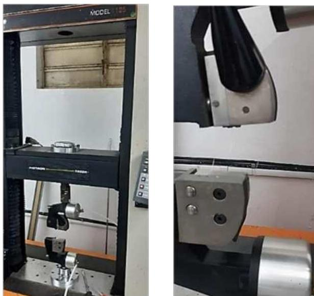
Figura 2. 7 Máquina de pruebas universales marca Instron modelo 1125 con mordazas para fibras
