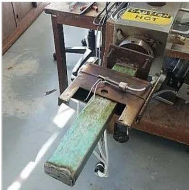
Figura 2. 10 Dado formador del perfil (sistema de inyección modificado)
