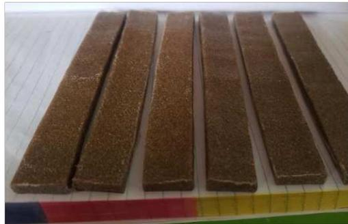
Figura 3. 15 Probetas elaboradas para los ensayos a flexión
