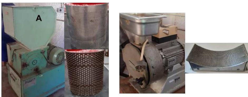
Figura 2. 4 Molino Pagani 1520 con cribas de 4 y 2 mm (A) y molino Brabender con criba de 1 mm (B)
