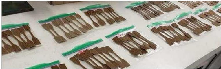
Figura 2. 9 Probetas tipo IV de materiales compuestos fibra-PP
