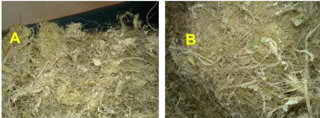
Figura 3. 1 Fotografías del bagazo de henequén (a) y de las fracciones fibrosas (b)
