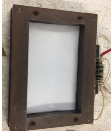
Figura 3.3. Corte de láminas de PEAD en medidas de largo (25cm) y ancho (12.5cm) para poder adaptarse al molde del material compuesto.
