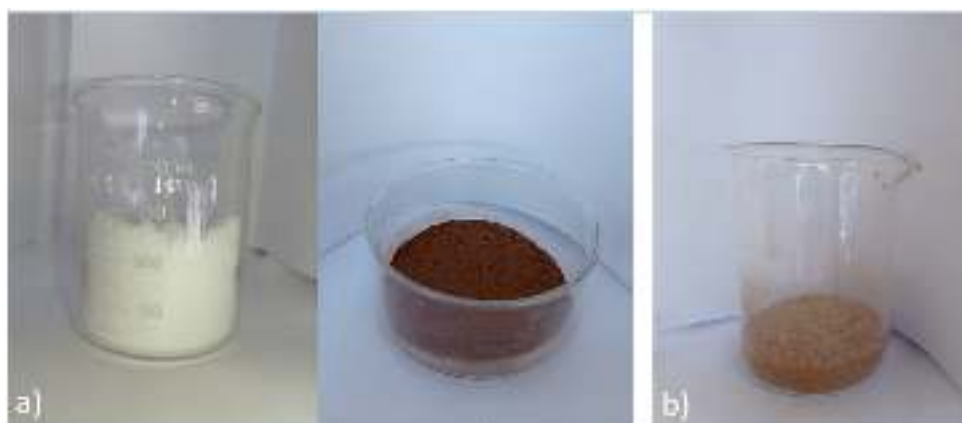
Figura 2.2. a) Muestra CUB (10 g) y sargazo SP (10 g). b) Muestra de cubrebocas mezclado con sargazo, MIX.
