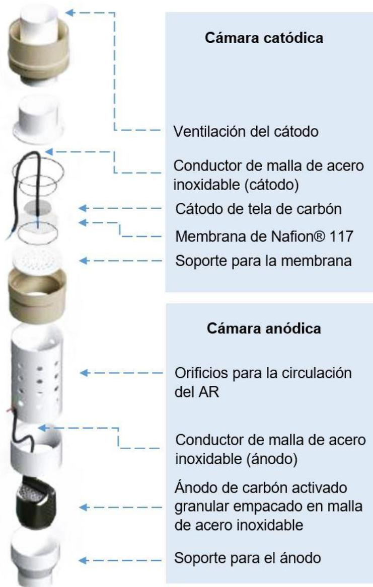
Figura 2.3. Estructura y composición de las CCM utilizadas (adaptación [7]).
