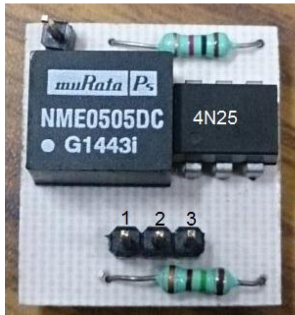
Figura Anexo 11.3 Driver resultante con un opto acoplador 4N25 y un dispositivo CD-CD.
