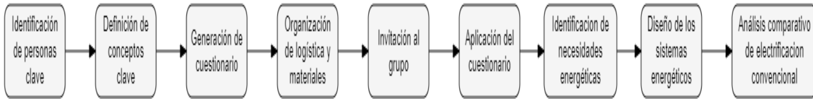
Figura 3.12. Diagrama de flujo del modelo efectivo de suministro energético.
