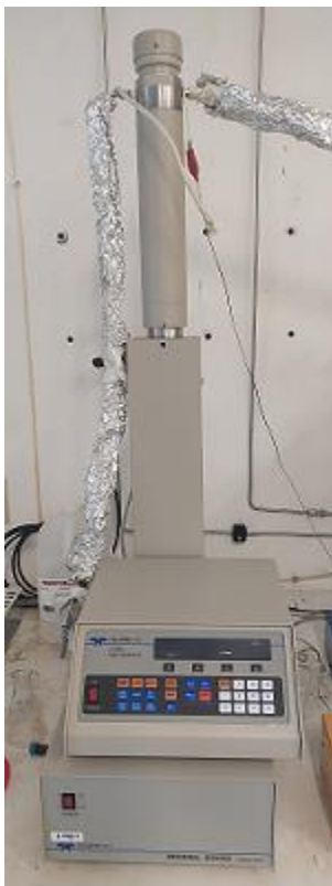
Figura 3.4 Bomba de tipo jeringa serie D Teledyne ISCO
