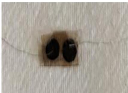
**Figura 3.5.** Fotografía de la unidad DHE desarrollada. El espacio entre los extremos de los dos cables de Pt es de aproximadamente 1 mm.
