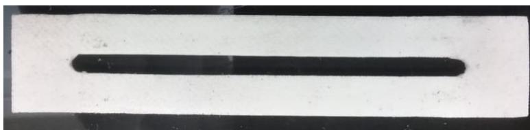
**Figura 3.3** Canales de flujo de la FC: a) canal de flujo de Silastic J para el ánodo, b) canales de flujo de Mylar para el cátodo.
