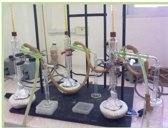
Figura 7. Sistema de destilación integral.
