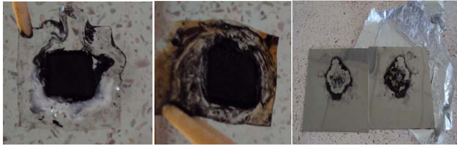
Figura 3.13 Ensamblas membrana-electrodos con capa catalítica depositada en membrana electrolítica preparadas con solvente de carbonato de propilo.
