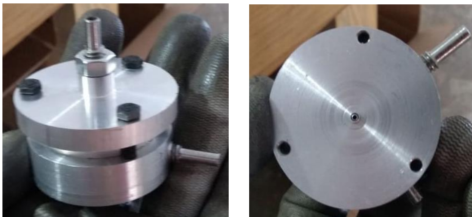
Figura 3.5. Diseño del spinneret utilizado en pruebas piloto.
