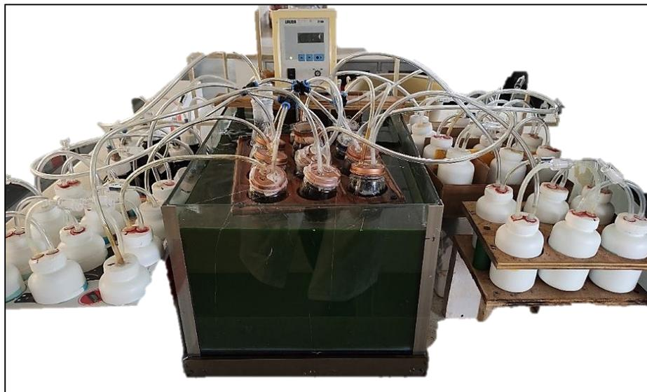
*Figura 8. Sistema de biodegradación aeróbica de materiales compuestos.*
