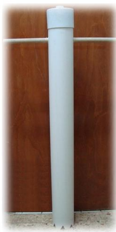
Figura 2.2 Nucleador utilizado para el muestreo de sedimentos en este estudio
