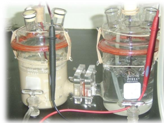
Figura 2.3 CCMS tipo “H” utilizada durante la Fase 1 de la estrategia experimental
