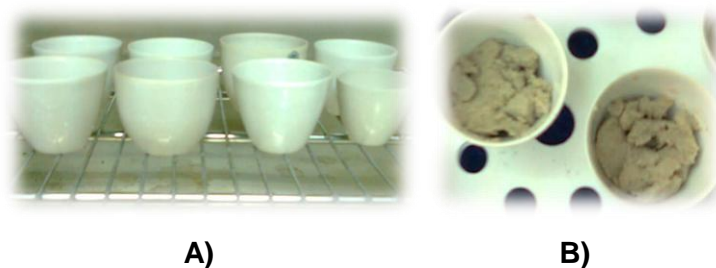
Figura 2.4 Ilustración correspondiente a la determinación de sólidos totales: A) Crisoles a peso constante, B) Muestra deshidratada (105°C por 24 horas).
