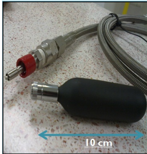
Figura 3.6. Tanque de hidruro metálico con 20L de capacidad.
