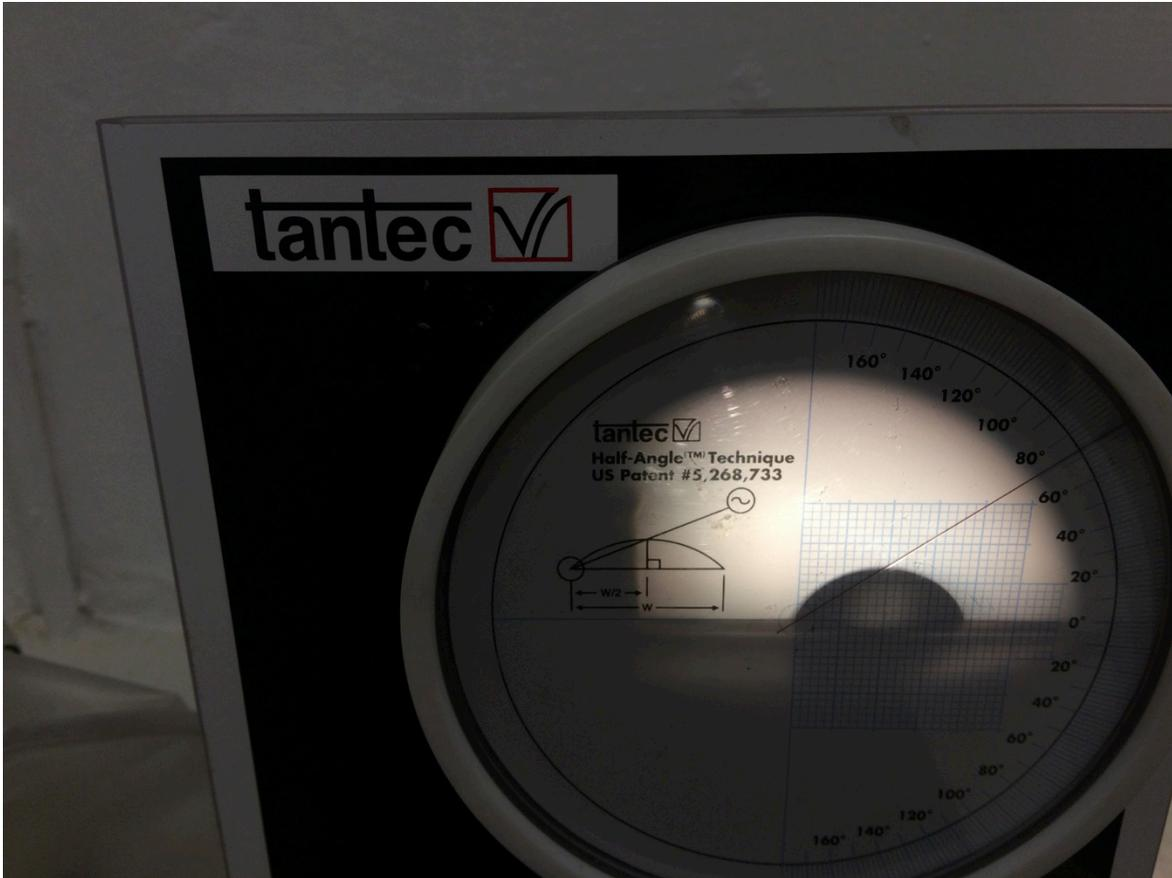
Figura 2.1. Medición del ángulo de contacto mediante el método de gota sésil.
