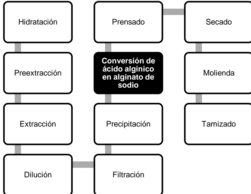
Figura 1.10. Diagrama del proceso de extracción de alginato [26]
