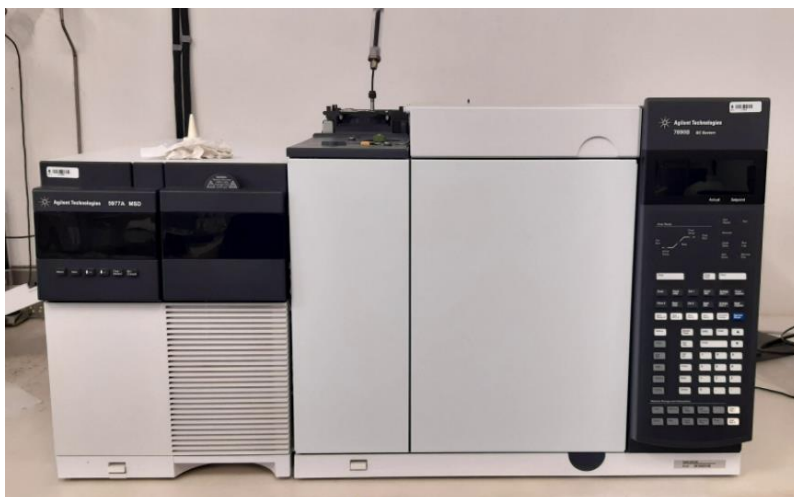
Figura 2.8. Cromatógrafo de gases Agilent 7890B GC acoplado a un espectro de masas Agilent 5977B GC/MSD
