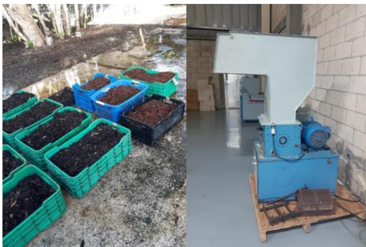
Figura 2.3. Lavado del sargazo y molino Pagani Serie 25
