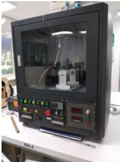
Figura 2.11. Máquina de electrohilado marca TONGLI modelo TL 01. En la parte frontal se encuentra el regulador de voltaje, amperaje, así como los botones de arranque y de la luz.
