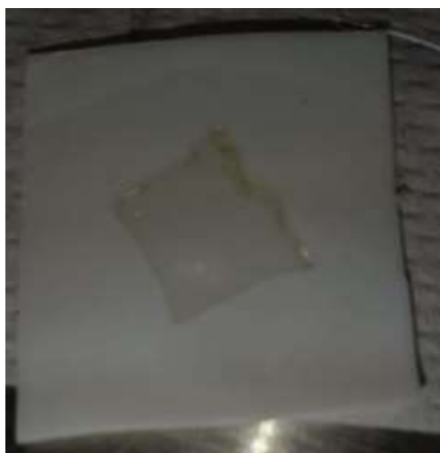
Figura C.1. Macroestructura del andamio CLG-EDC-NHS
