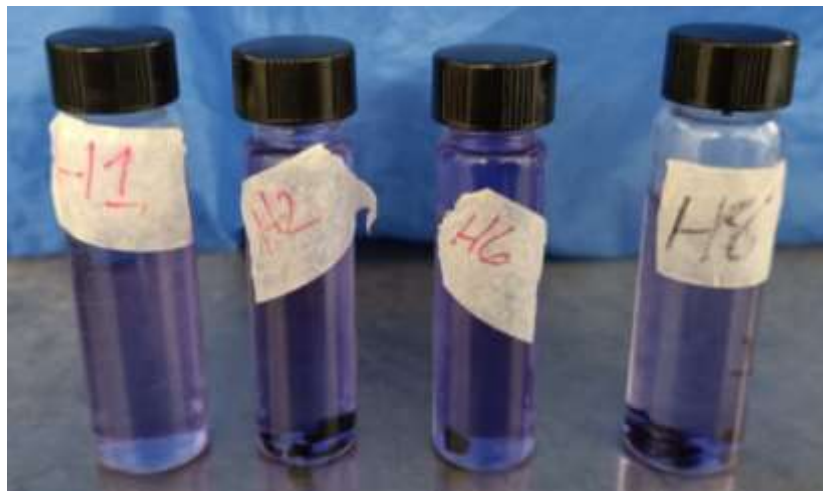
Figura 3.20. Índice de entrecruzamiento por ensayo de ninhidrina de los andamios. Viales con la solución de ninhidrina posterior a la reacción con los grupos amina libres de los andamios electrohilados. H1, andamio CLG. H2, andamio CLG-GTA. H6, andamio CLG-AH. H8, andamio CLG-AH-GTA.
