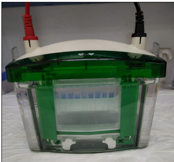
Figura 2.9. Cámara de electroforesis Mini-Protean 3 Cell, (Bio-Rad, EE. UU.
