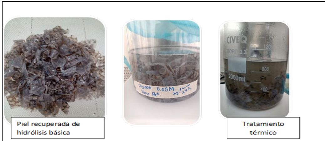
Figura 2.3. Proceso de solubilización.
