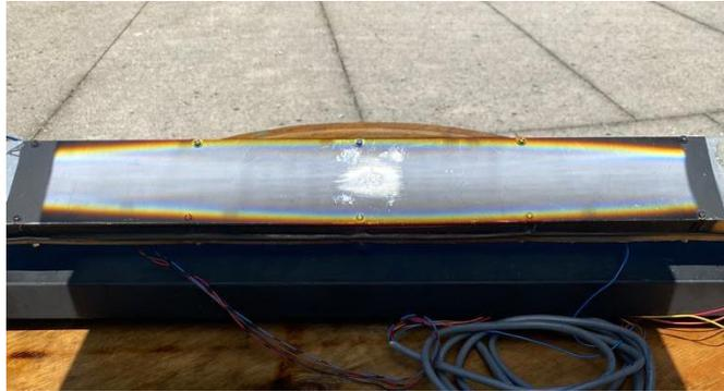
Figura 2.6. Concentración de rayos solares sobre la base disipadora debido a la lente Fresnel.
