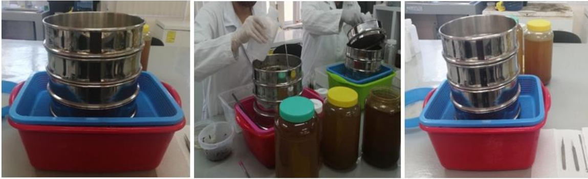
FIGURA 9. Tren de tamizado y proceso de separación de la fauna asociada y tamizado de muestras de sargazo.
