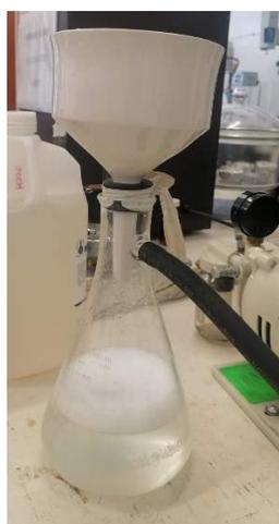
**Figura 2.7** Filtrado al vacío del producto obtenido de la síntesis
