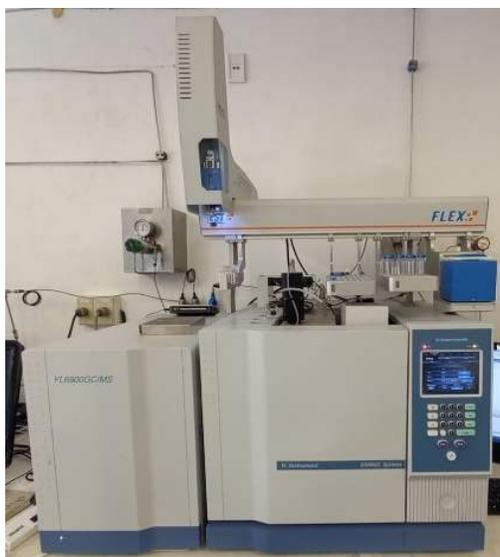
**Figura 2.14** Cromatógrafo de Gases YL6900, detector de masas YL900 y EST-Analytical-FLEX
