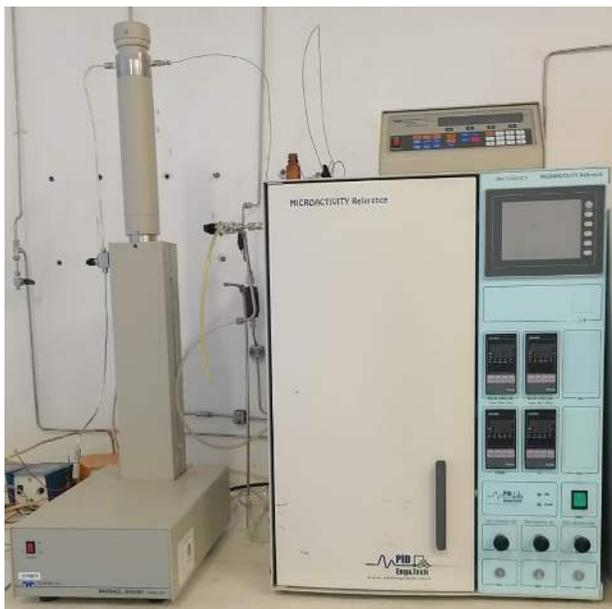
**Figura 2.13** Reactor de lecho fijo Microactivity-Reference marca PID Eng & Tech
