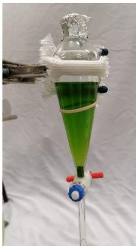
**Figura 2.2** Extracción lipídica con cloroformo-metanol
