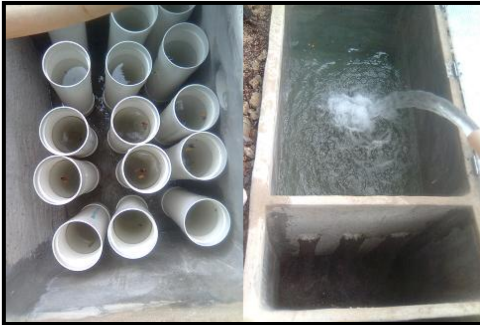
Figura 2.18. Llenado de la fosa séptica modificada para pruebas de estanqueidad.
