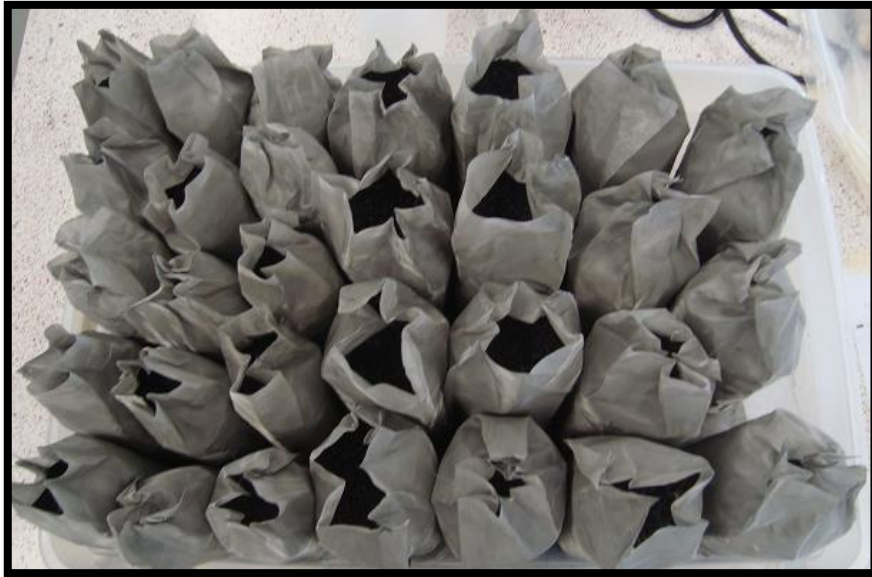
Figura 2.17. Electrodo hecho de malla de acero inoxidable que contiene carbón granular.
