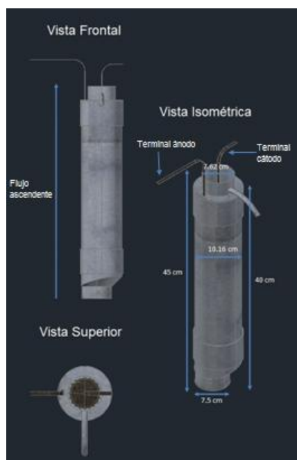
Figura 2.11. Diferentes Vistas así como medidas de la CCM.
