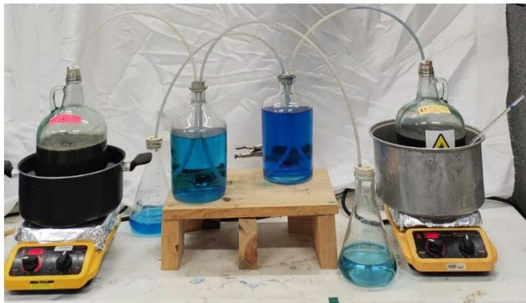
**Figura 2.5** Pruebas de fermentación oscura y medición de biogás (hidrógeno) mediante desplazamiento de volumen.
