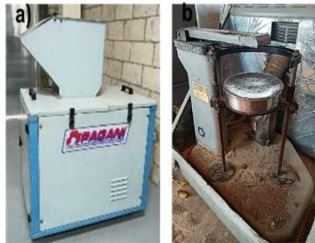
Figura 3.3. a) Molino Pagani mediano, modelo 1620 ST b) Ro-tap modelo R-30050.
