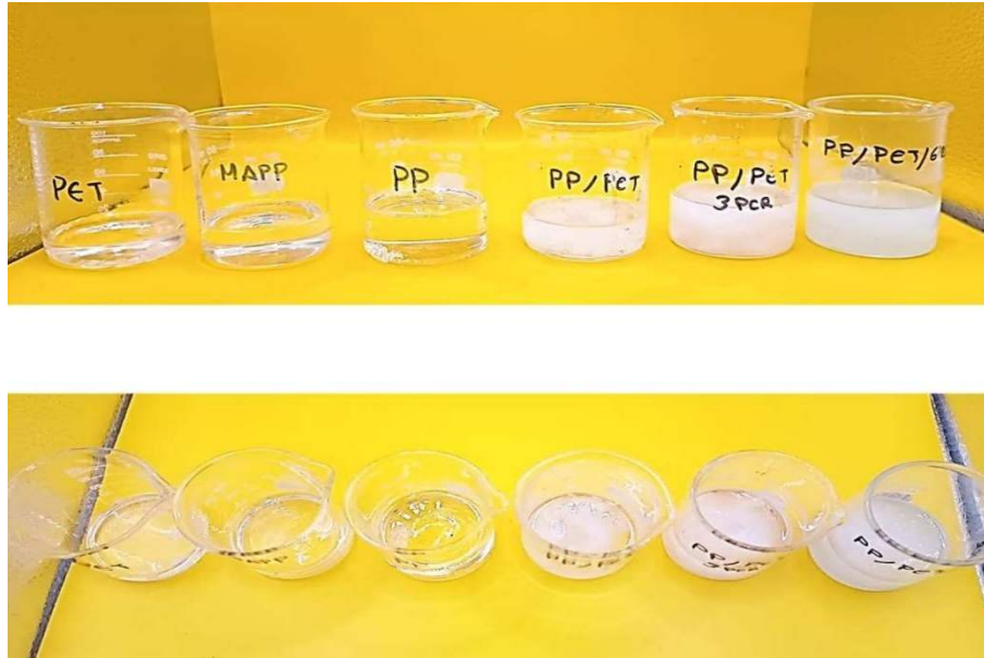
Figura 4.10. Muestras de: rPP, MAPP, rPET, rPP/rPET, rPP/rPET/3 MAPP, rPP/rPET/6 MAPP después de 3 horas a temperatura 110 °C, sumergida en p -xileno.
