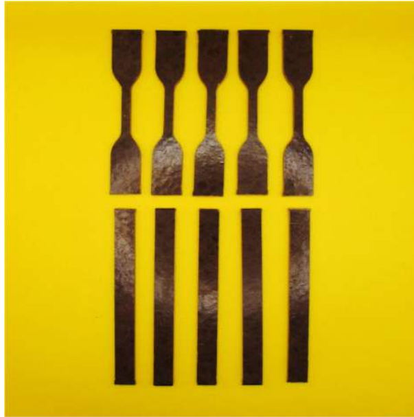
Figura 3.14. Probetas de tensión y flexión-rPP/rPET/3 MAPP/FC/HM/MAPP con base al arreglo ortogonal L9.
