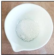
**Figura 2. 16.** Soporte secado a temperatura ambiente posterior a su hidratación con H<sub>2</sub>O destilada para la prueba de saturación del poro.
