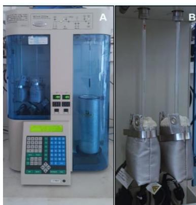
**Figura 2. 22.** A) Equipo Quantachrome NOVA2200E en degasificación. B) Celdas dentro de la mantilla térmica a 100 °C.
