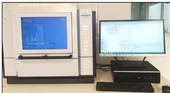
**Figura 2. 20.** Equipo Bruker D8-Advance utilizado para el análisis de DRX del catalizador sintetizado.
