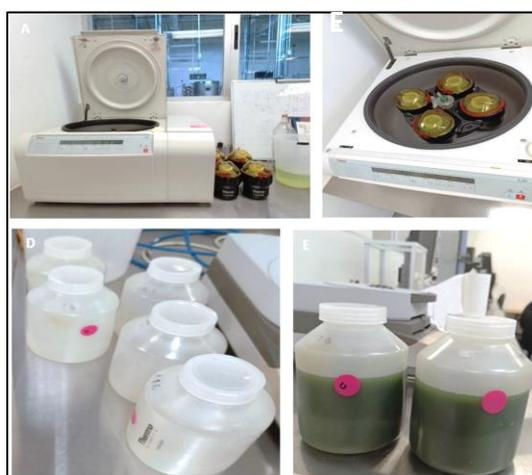
**Figura 2. 6.** A) Centrífuga industrial *Thermo Fisher Scientific SL40R*, B) Contenedores dentro de centrífuga, C) Contenedores de 500 mL vacíos y D) Contenedores de 500 mL con biomasa líquida.
