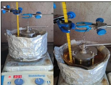
**Figura 2. 14.** Baño de parafina donde se colocó el autoclave que contiene en su interior el vaso de teflón con las soluciones de síntesis.
