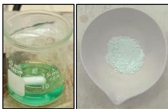
**Figura 2. 17.** Impregnación Ni y secado a temperatura ambiente durante 24 h.
