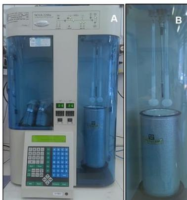
**Figura 2. 23.** A) Equipo Quantachrome NOVA2200E en medición y B) Celdas después de ser medidas dentro del Dewar con nitrógeno líquido.
