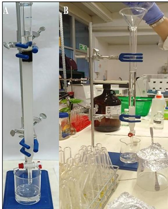
**Figura 2. 10.** Empacado de la columna con la adición de hexano y sílica gel. A) Se observa la columna preparada con la cabeza y B) Se observa el procedimiento de empacado en la columna *marca ESEVE, 2427*.
