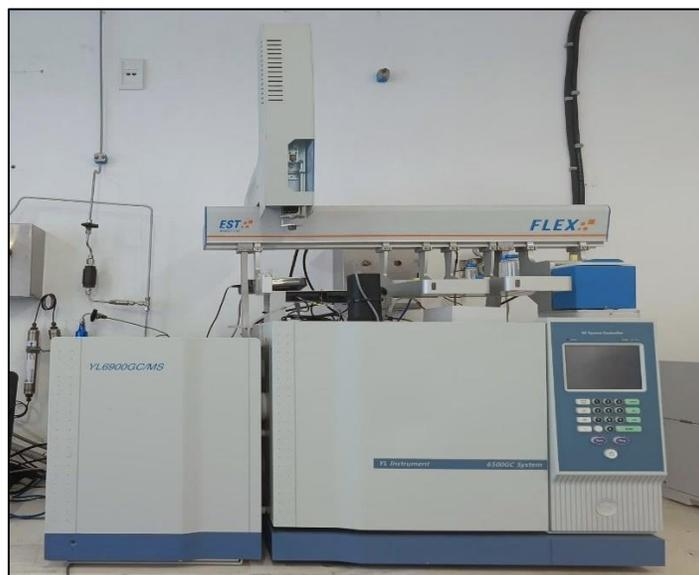
**Figura 2. 26.** Cromatógrafo de gases acoplado a espectrómetro de masas (CG-EM) YL6900, con equipo de inyección EST-Analytical-FLEX
