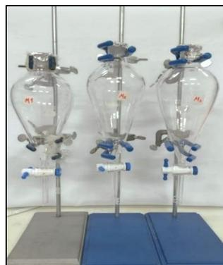
**Figura 2. 8.** Embudos de separación en soportes universales, donde se colocaron los extractos.
