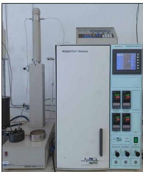
**Figura 2. 24.** Reactor de lecho fijo Microactivity-Reference marca PID Eng & Tech.
