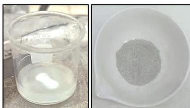
**Figura 2. 18.** Impregnación del molibdeno Mo y secado a temperatura ambiente durante 24 h.
