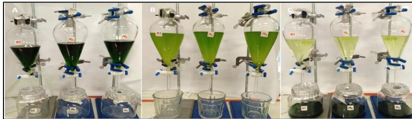
A) Extracción por triplicado en embudos de separación: A)primera, B) segunda, c) tercera.
