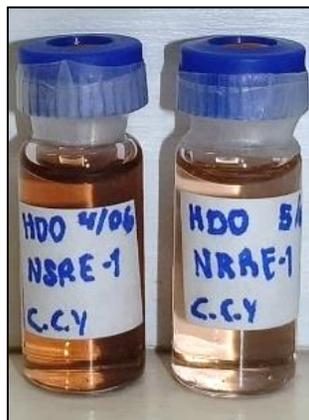
**Figura 3. 19.** Muestras de 1mL del producto de la reacción HDO de las materias primas empleadas de NSRE-1 y NRRE-1.
