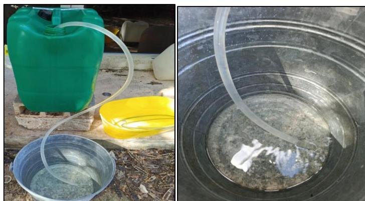
**Figura 2. 5.** Se observa el procedimiento de sifonado de cultivos, posterior a la floculación.
