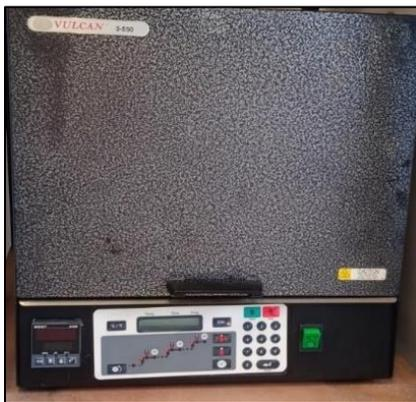
**Figura 2. 12.** Mufla marca Vulcan 3-500 donde se realizaron las calcinaciones en diversas etapas de la síntesis del catalizador.
