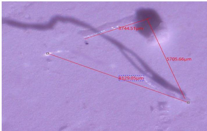
**Figura 14. Fotografía de las medidas de los MP's (muestra agua/ temporada lluvia) capturada con TopView.**
