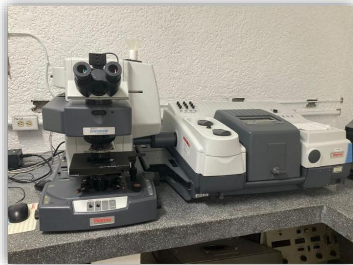
**Figura 15. Equipo de espectrofotometría FTIR (Nicolet 8700) utilizado para la identificación de polímeros.**
