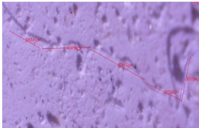
**Figura 13. Fotografía de las medidas de los MP's (muestra agua/temporada seca) capturada con TopView.**
