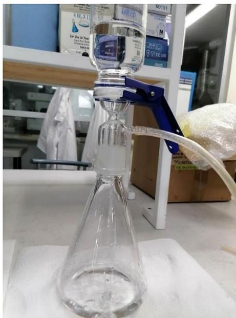
**Figura 5. Filtración de muestras de agua Mili-Q en el sistema de cristal con filtros de celulosa.**
