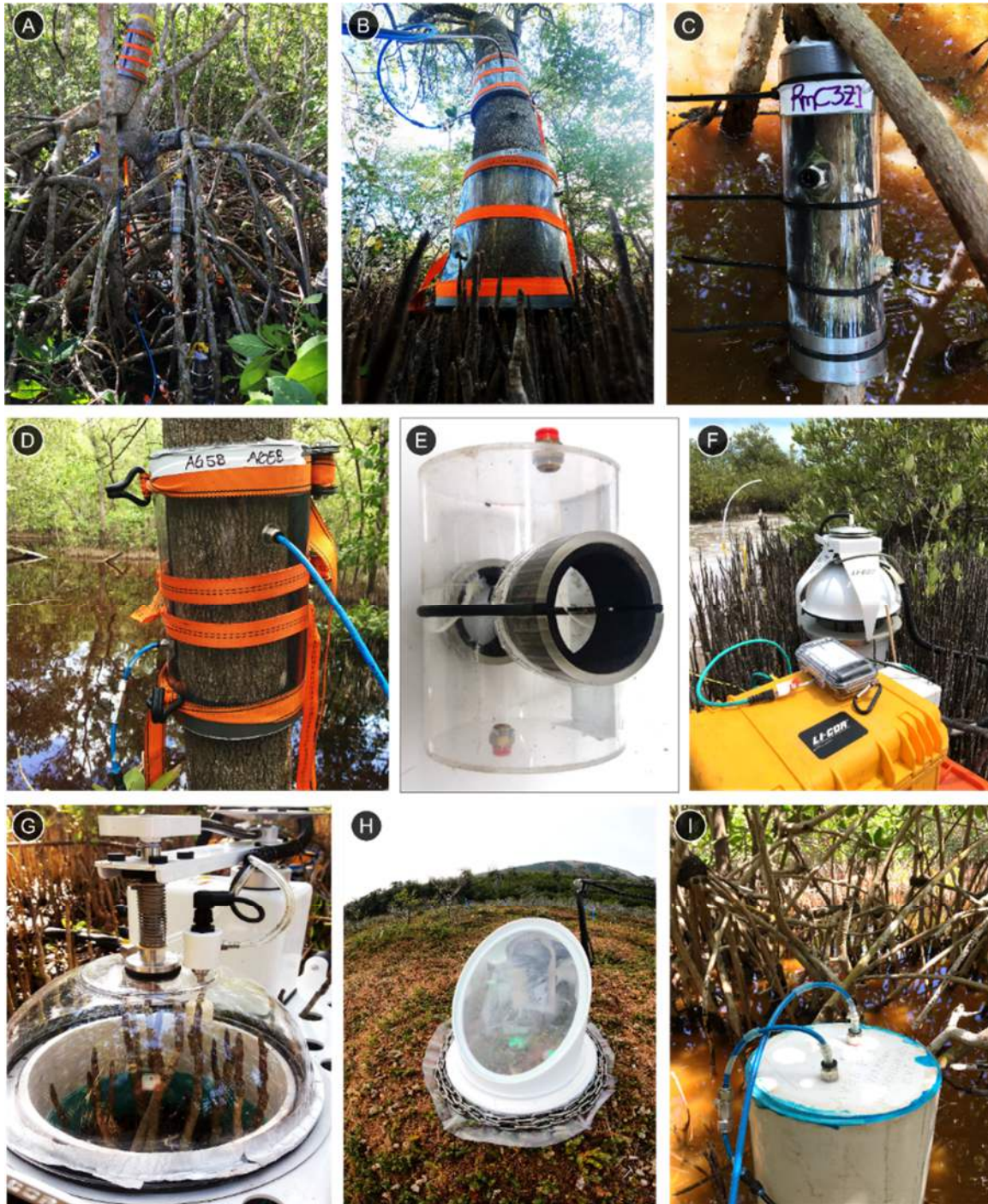
Figura 1.4. Cámaras para la medición de flujos de gases en suelos y compartimentos vegetales. A–D. Cámara semirrígida para la medición en tallos y zancos en árboles. E. Cámara rígida para medición en tallos. F.G. Cámara de sistema cerrado dinámico para medición en suelo y neumatóforos. H. Cámara ‘skirt’ de sistema abierto para medición en turberas (Thalasso et al. , 2023). I. Cámara de sistema cerrado para medición en la interfaz agua–aire.
