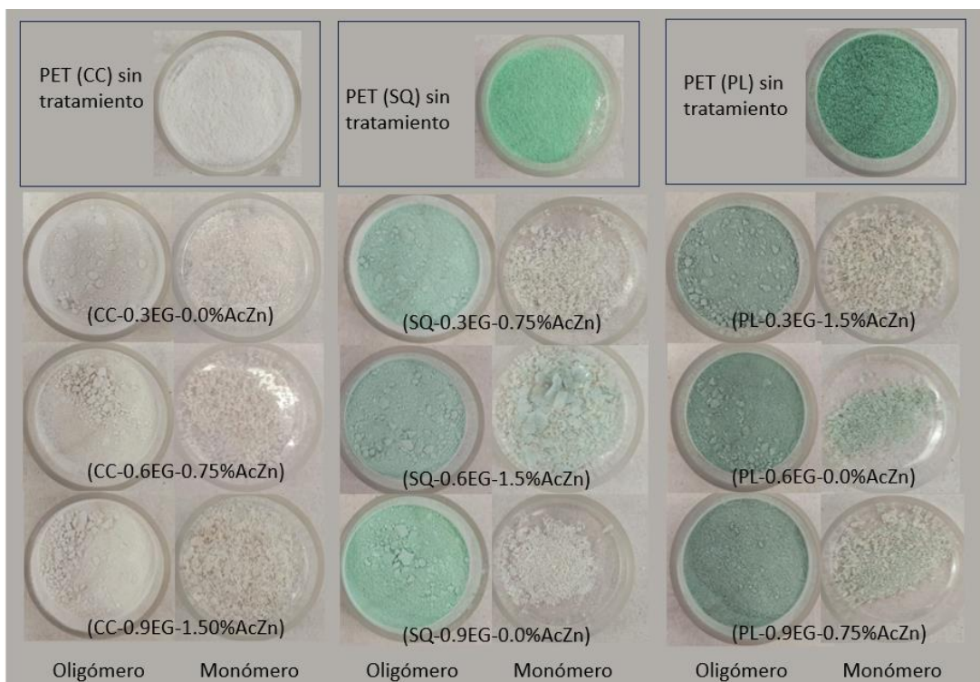
Figura 0.26. Comparación visual de PET en polvo sin tratamiento y sus productos glicolisados por REX a diferentes condiciones, separados en fracciones oligomérica y monomérica.
