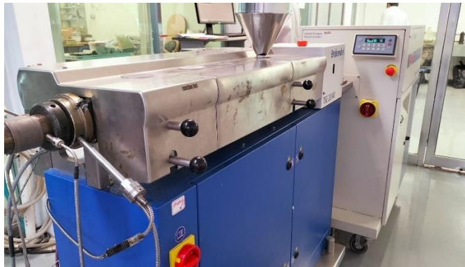
Figura A.2. Extrusor modular de 6 zonas con relación L/D = 40 utilizado para optimizar la glicólisis por REX.
