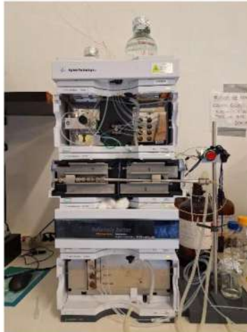
Figura 2.3: Cromatógrafo Líquido de Alta Resolución HPLC con columna Metacarb 87H 300 x 7.8 mm (Aglient).
