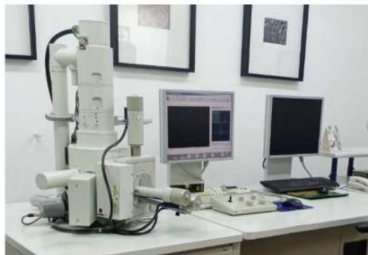
Figura 2.5: Microscopio Electrónico de Barrido (SEM), JSM-6360L, JEOL
