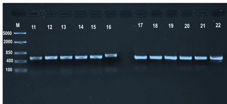
**Figura 2.20.** Imagen en gel de agarosa al 1.1% de la región amplificada por PCR de aislados fúngicos en hojas de *A. mexicana* en la temporada 2022. Marcador de peso molecular (5Kb). Carril 11-16 con los ITS 1/4, y del 17-22 con TEF-1 $\alpha$ .
