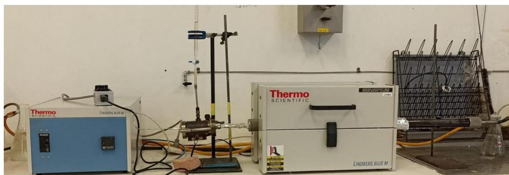
Figura 3.1 Montaje del sistema de síntesis verde de los CNT, se incluye la bureta, vaporizador y el horno de pirólisis.
