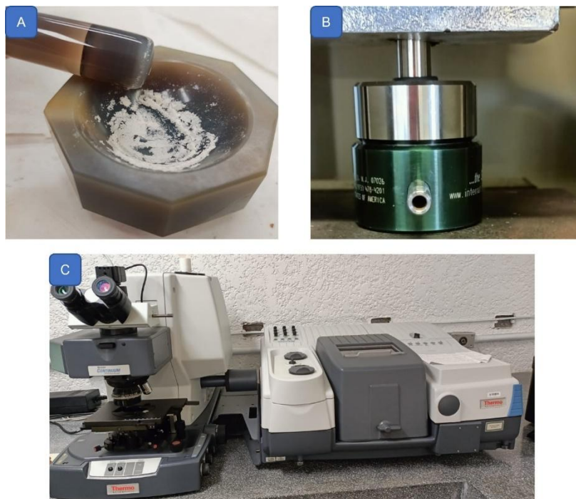
Figura 9. Preparación de las poliamidas para el análisis en FTIR. A) Trituración de la muestra. B) Fabricación de las pastillas. C) Análisis en FTIR.
