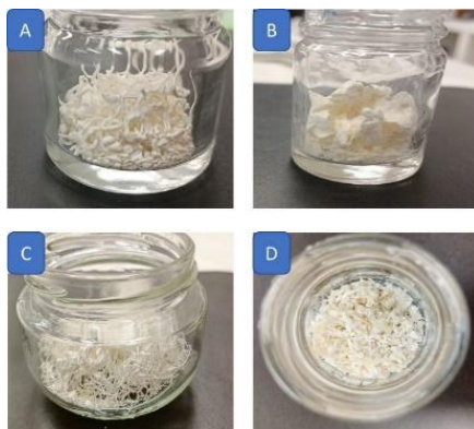
Figura 12. Obtención de las copoliamidas obtenidas mediante la síntesis de policondensación directa. A) co-PTFA, B) co-PHFA, C) co-PMBD y D) co-PDED.
