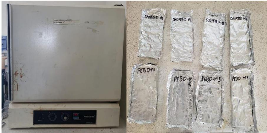
Figura 14: Horno de convección de aire forzado
