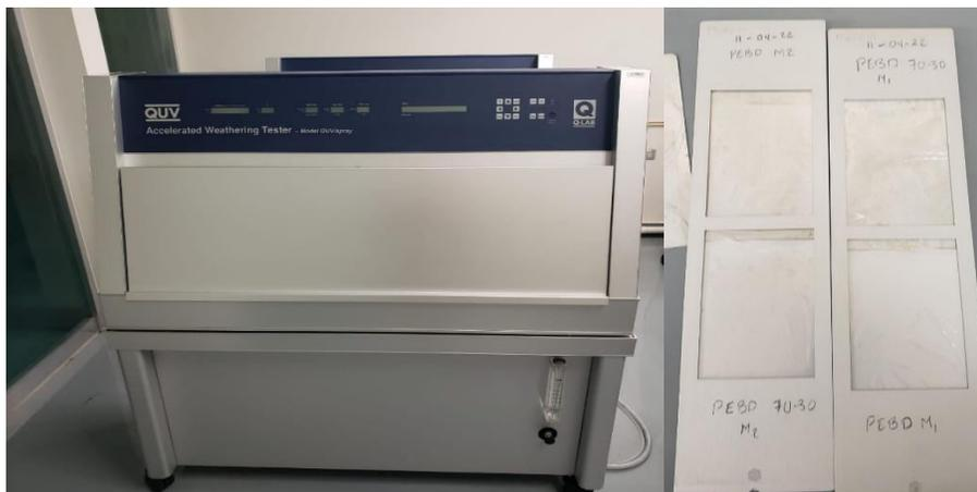
**Figura 15:** Cámara de envejecimiento acelerado
