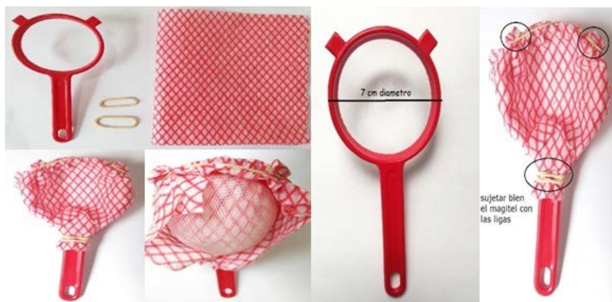
Figura 7. Elaboración de red de muestro usando el colador y paño de limpieza tipo Magitel™.
