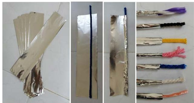
**Figura 14.** Formación de rollos de aluminio con el material conductor, a) tiras de aluminio, b) posición del cordón sobre el aluminio, c) enrollado inicial del aluminio, d) vista final del extremo descubierto del rollo.
