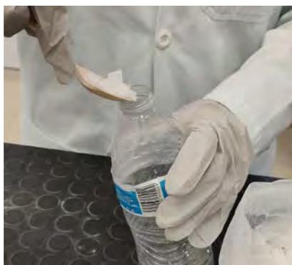
**Figura 9.** Agregar con mucho cuidado dos cucharadas de sosa cáustica a la botella que contiene ¼ de taza de agua. No debes tomar la botella de la base para evitar quemaduras. Tampoco acercar tu cara a la boca de la botella, de la cual pueden emanar vapores corrosivos e irritantes. Al terminar puedes dejar destapada la botella, ya que así se requerirá para el siguiente paso.
