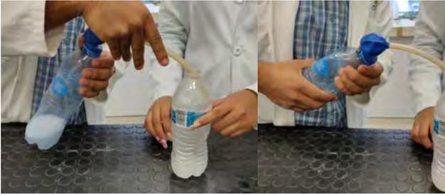
**Figura 11.** Izquierda: vaciado del CO<sub>2</sub> en la botella con la solución de sosa cáustica. Derecha: se aprieta la botella para expulsar más CO<sub>2</sub>, cuidando de no expulsar el líquido que contiene.
