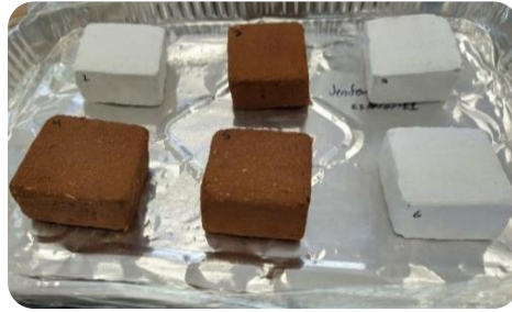
Figura 2.7 Muestras de material para la prueba de obtención de las isothermas de sorción.
