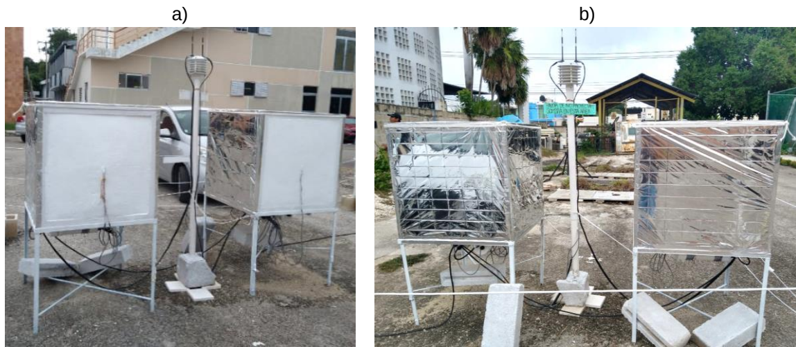
Figura 2.26 Celdas experimentales: caras aisladas con superficies aluminizadas.
