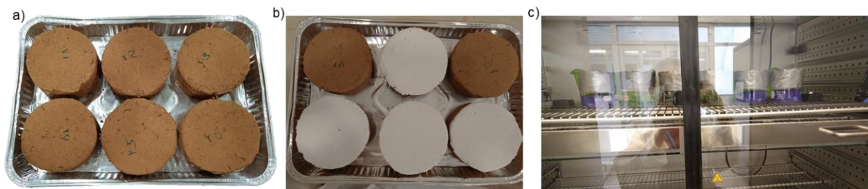
Figura 2.6. Prueba de permeabilidad al vapor de agua: a) Muestras del material de tierra, b) incorporación de un recubrimiento permeable al vapor de agua, y c) arreglo experimental.
