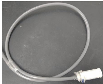
Figura 2.15 Sensor de temperatura y humedad relativa con funda de polietileno.
