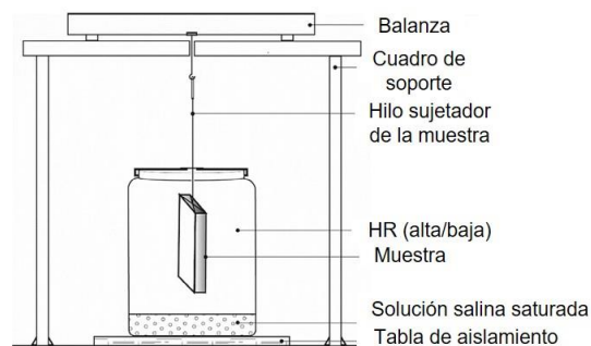
Figura 1.4 Configuración experimental modificada para el cálculo del MBV [3].
