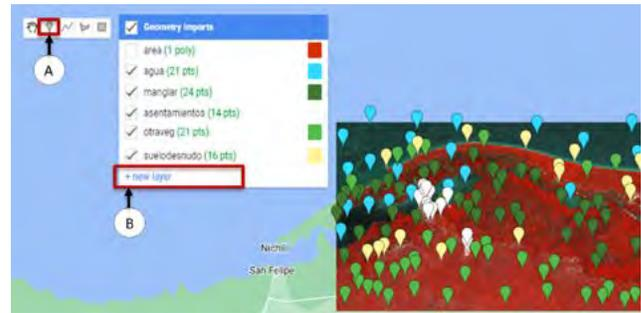
**Figura 11.** Puntos de entrenamiento generados en Google Earth Engine. A) Herramienta que nos ayuda a añadir marcadores en el mapa, y B) generación de capas, las cuales podemos modificar (imagen generada en Google Earth Engine en 2023).
