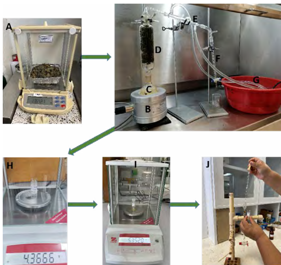
Figura 8. Proceso de destilación por arrastre de vapor: A) báscula para pesar hojas, B) manta de calentamiento, C) matraz balón con agua, D) columna con hojas, E) condensador, F) bureta (separa el agua del aceite), G) flujo de agua fresca, H) registro de peso de vial sin aceite, I) peso del vial con aceite, J) separación del aceite (Fotografías: Rosa Grijalva A., 2023).
