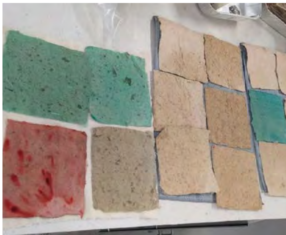
Figura 18. Secado al ambiente sobre tela absorbente (Imagen tomada por GCE, SDA e IFS, 2023).
