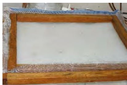
Figura 16. Formación de una capa de fibras sobre una malla (Elaborado por GCE, SDA e IFS, 2023).
