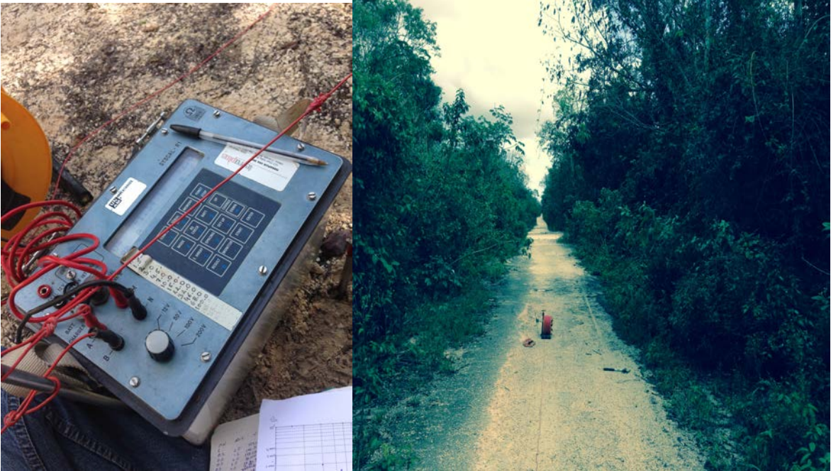
Resistivímetro utilizado y caminos donde se realizaron los sondeos eléctricos verticales.
