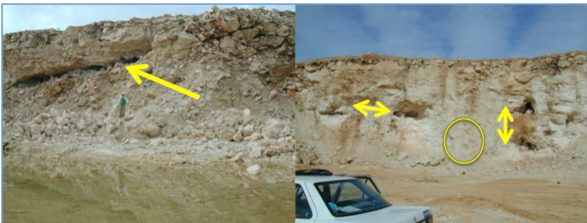
Figura 45.- Triple porosidad del sistema [Matriz (círculo), fracturas y conductos de disolución (flechas)] (Adaptado de Marín et al., sin publicar).
