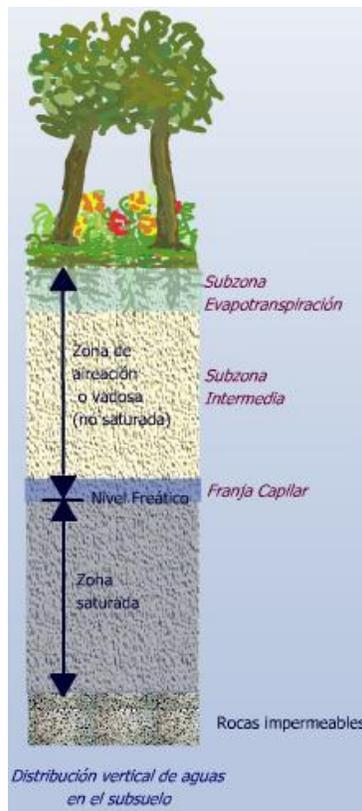
**Figura 1. 1** Zona vadosa o no saturada y zona saturada que distingue el transporte de contaminantes por infiltración (Univ. Complutense, 2013).
