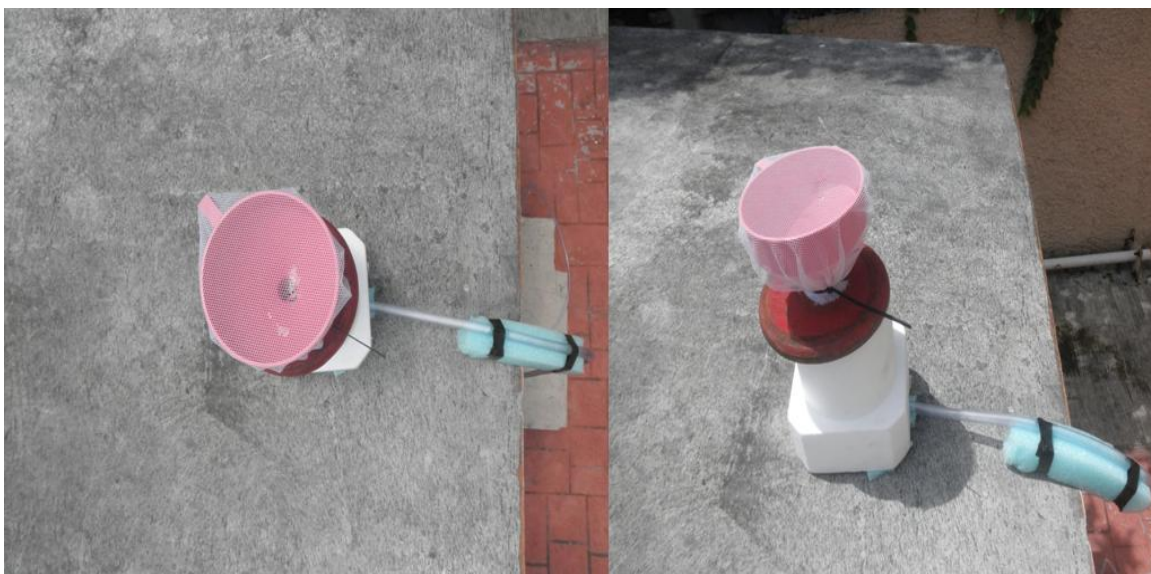
Figura 3-1. Pluviómetro instalado en la UCIA.
