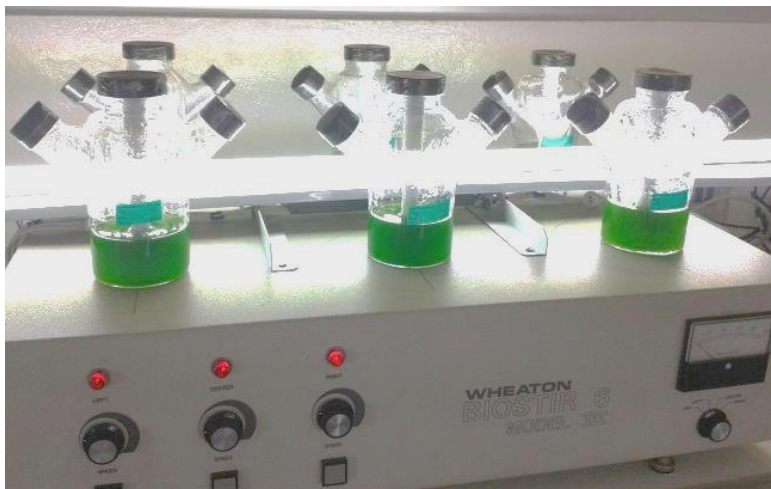
Figura 2. 2. Sistema de cultivo Wheaton, con matraces Celstir y Agitador Biostir 6 modelo III
