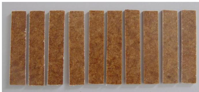
*Figura 24. Probetas sin ranura para prueba de impacto izod*
