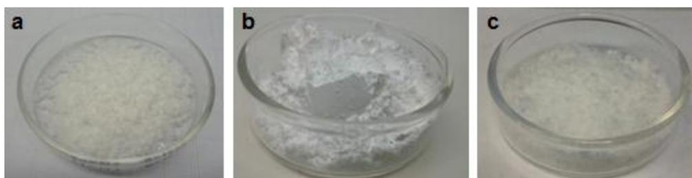
*Figura 13. a) Ácido esteárico, b) estearato de zinc y, c) cera de parafina*
