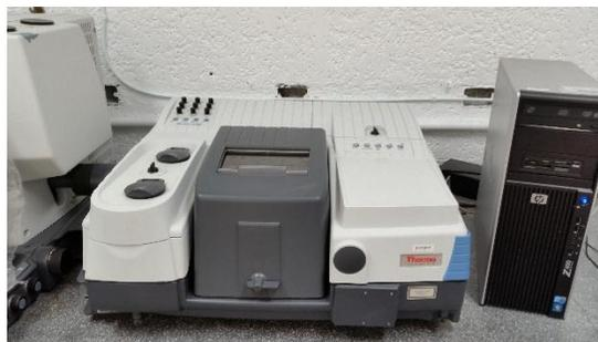
*Figura 29. Espectrógrafo de infrarrojo con transformada de Fourier*
