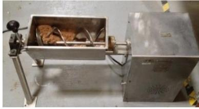
*Figura 18. Mezcladora de cintas modelo ML-5*
