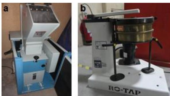
*Figura 14. a) Molino pagani modelo 2030 y, b) Rotap modelo RX-30*
