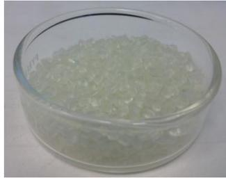
*Figura 10. Polipropileno injertado con anhídrido maleico*
