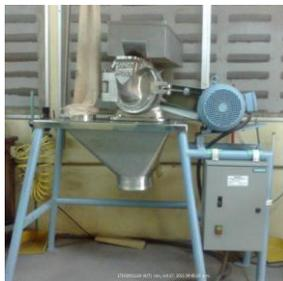
*Figura 16. Molino-Pulverizador Veyco modelo MPV 250*
