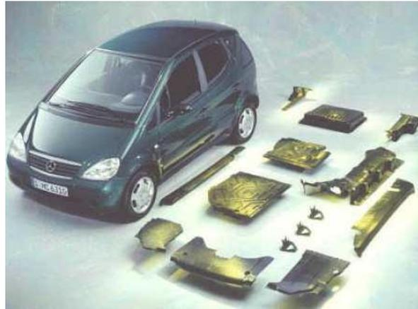
*Figura 1. Componentes elaborados con fibras naturales en un automóvil Mercedes-Benz [23]*
