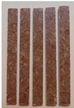
Figura 27. Probetas para ensayo a flexión
