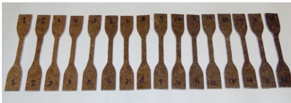
*Figura 25. Probetas tipo IV para prueba de tensión*
