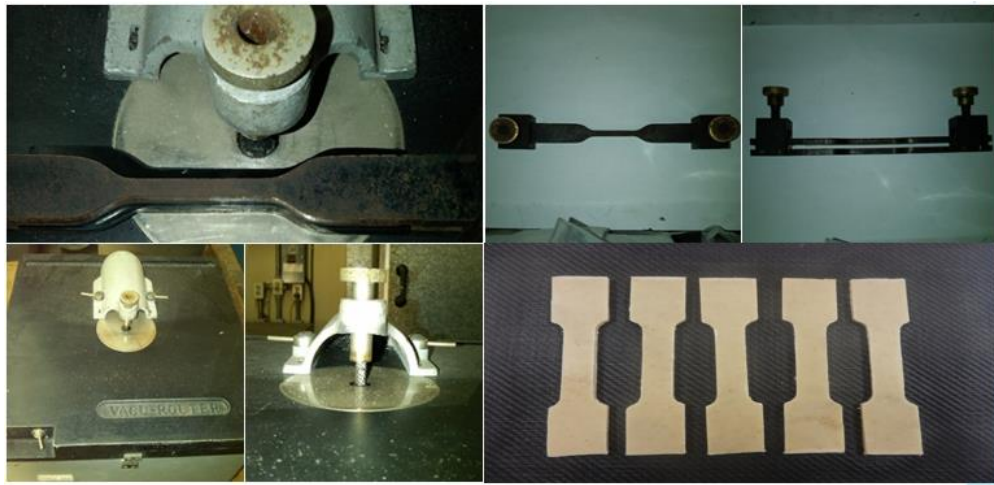
Figura 20. Router, Molde tipo IV y probetas de tensión.
