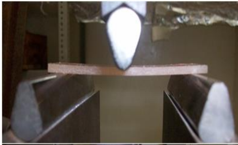
Figura 27. Máquina shimadzu adaptada para el ensayo a flexión en 3 puntos.
