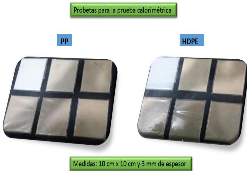
Figura 25. Probetas para la prueba de calorimetria de las diferentes formulaciones.
