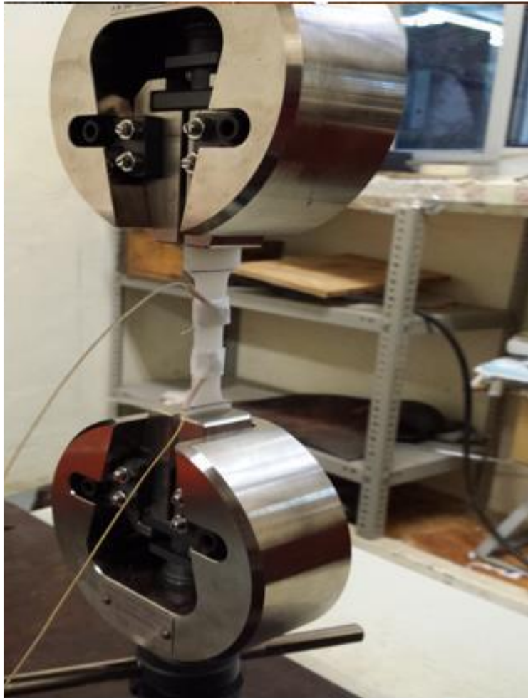
Figura 26. Máquina shimadzu adaptada con emisión acústica para las pruebas de tensión.
