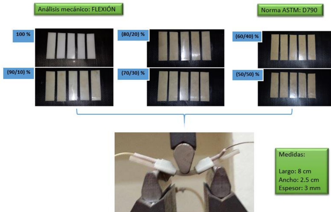
Figura 23. Probetas de flexión de las diferentes formulaciones y los parametros del ensayo.
