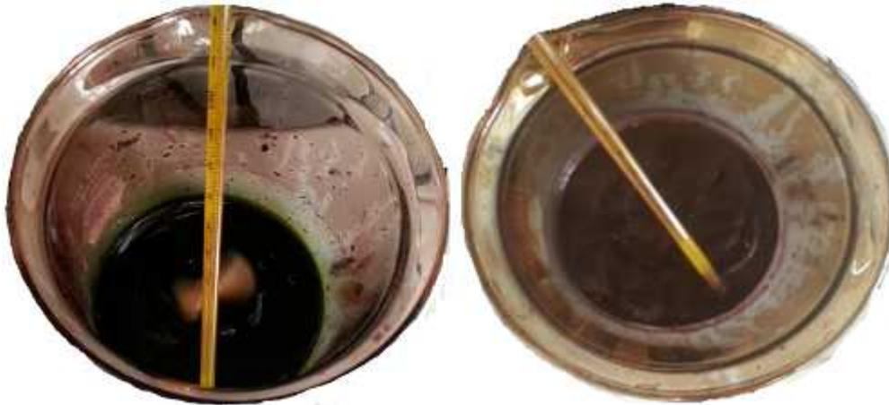
*Figura 3-1. Mezcla de grafito y ácidos. En la imagen de la izquierda se muestra el momento inmediato en que fue depositado el  $\text{KMnO}_4$ . En la imagen de la derecha se observa la mezcla después de 14 horas de reacción.*
