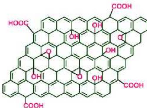
Figura 1-3 Modelo simple del óxido de grafito [6]
