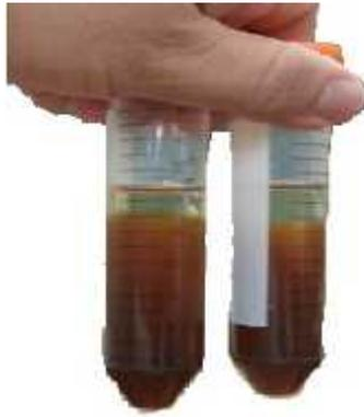
*Figura 3-2. Material de grafito después de ser lavado y centrifugado. Se observa una fase viscosa de color amarillo, que es el óxido de grafito, y una fase líquida, que es la mezcla de lavado y el  $\text{KMnO}_4$  no reaccionante.*
