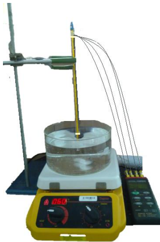
Figura A1. Sistema para medir la confiabilidad de los termopares del data logger.
