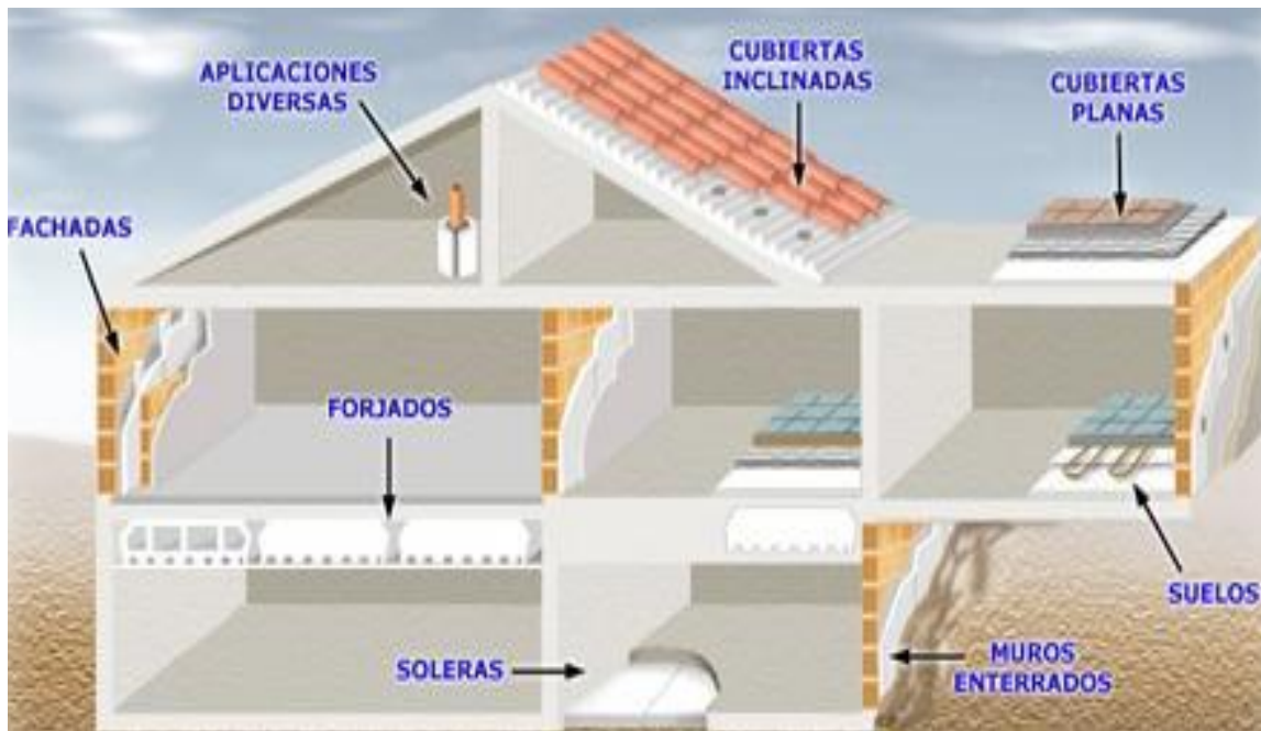
Figura 1.6. Aplicaciones del EPS en la construcción [35].
