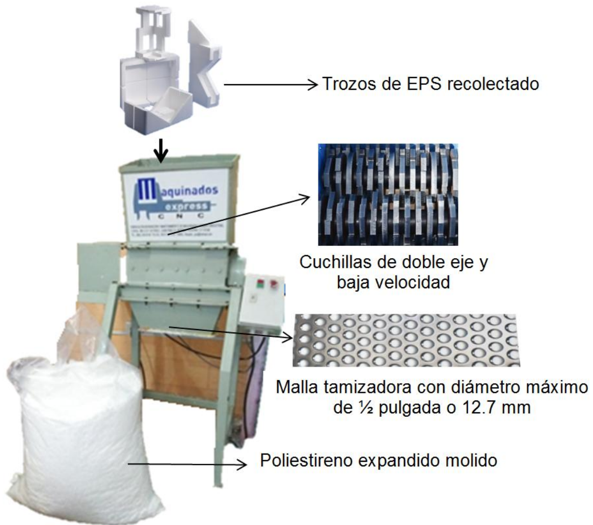
Figura 2.1. Características del molino utilizado para la molienda del EPS recolectado.
