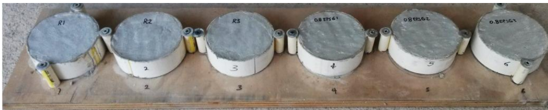
Figura 2.13. Moldes circulares para las pruebas acústicas.
