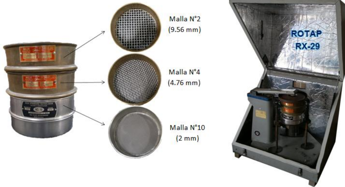
Figura 2.2. Mallas utilizadas en el proceso de tamizado del EPS triturado y equipo ROTAP perteneciente al CICY.
