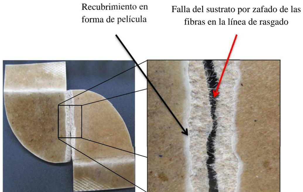
**Figura 3.14:** Falla por rasgado del material compuesto obtenido con dos aplicaciones de EPSr/LMNO.
