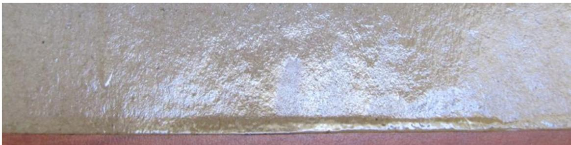
**Figura 3.1:** Exceso de recubrimiento sobre el extremo inferior de una muestra de papel Kraft tratada con una capa de látex acrílico aplicado por la técnica de inmersión.
